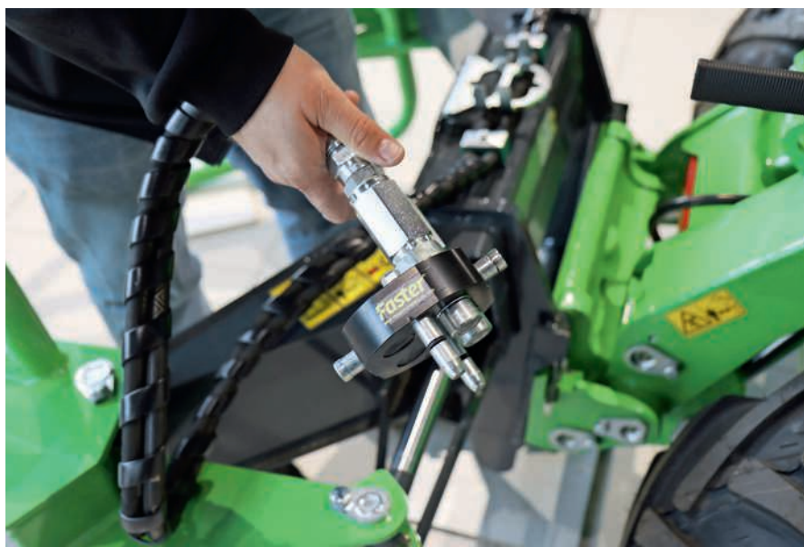
Vakiona olevalla sarjapikaliittimellä hydraulikka ja työlaitteen ohjauksen Opticontrol kytketään kevyellä vivun liikkeellä.
