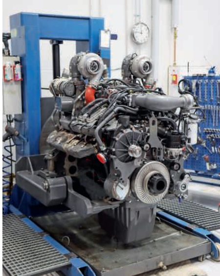
Koekäytössä jokainen moottori kuormitetaan ohjearvoihin. Moottoreiden tuottama voima hyödynnetään tehtaan sähkön-tuotannossa.
